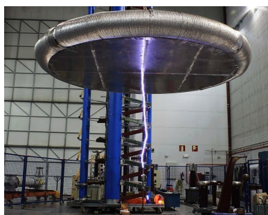
LCOE 1600kV超高壓測試
